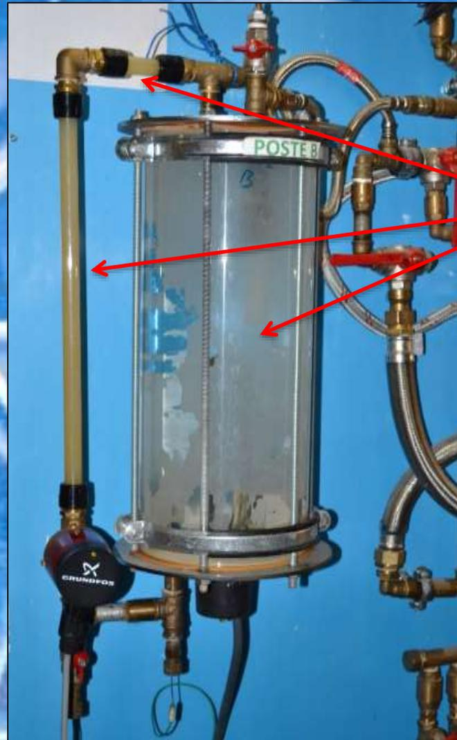
Incrustations de calcaire sur la paroi et dans les conduites
