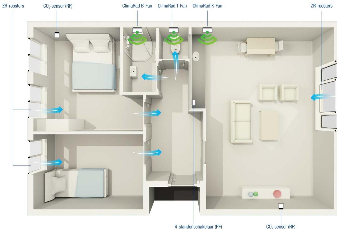
La solution « Classic » de ClimaRad est une solution dans laquelle l'air humide est évacué et où l'air frais entre dans les pièces de vie à travers d'ouvertures d'amenée dans les fenêtres. L'air vicié est évacué de façon décentralisée à travers les pièces humides (toilettes, salles de bain et cuisine) par le ClimaRad Fan, ClimaRad MiniBox ou ClimaRad MaxiBox.
