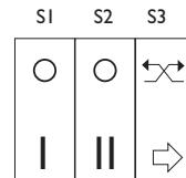
Interrupteur S3 active le mode "free cooling" (manuel), qui arrête les flux en alternance et maintient le ventilateur en mode extraction ou en mode insufflation, pour éviter l'échange de chaleur si nécessaire. Pour régler le "mode extraction" ou le "mode insufflation", positionnez les cavaliers intégrales selon figure. 21A ou fig. 21B. Le LED sur l'appareil indique quand le "free cooling" est activé.
