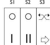
De S3-knop activeert de modus "vrije koeling" (bypass), deze stopt de alternerende luchtstroom en gaat over op de extractiemodus, of toevoermodus dit om warmteterugwinning te vermijden indien niet gewenst. Om de "extractiemodus" of de "toevoermodus" in te stellen, dient met de jumpers volgens fig.21A of fig. 21B te plaatsen.
